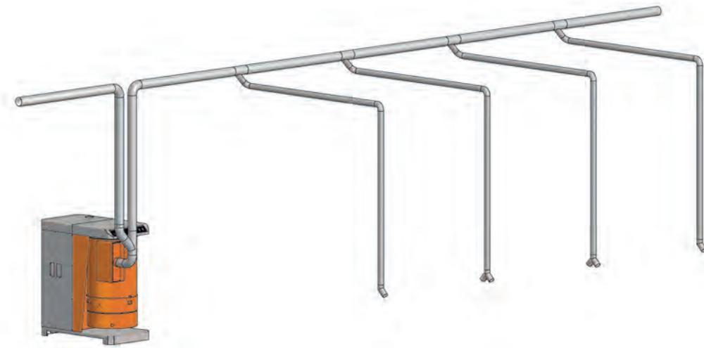
Para transportar el aire contaminado desde el punto de captación hasta el equipo de aspiración y filtración se utiliza un sistema de tuberías que se diseñan y montan según sus necesidades. El sistema completo es galvanizado y está compuesto de tubos, abrazaderas, piezas terminales, piezas T, reducciones y todas las otras piezas necesarias. Todas las piezas son resistentes al desgaste, ya que están hechas en acero.
