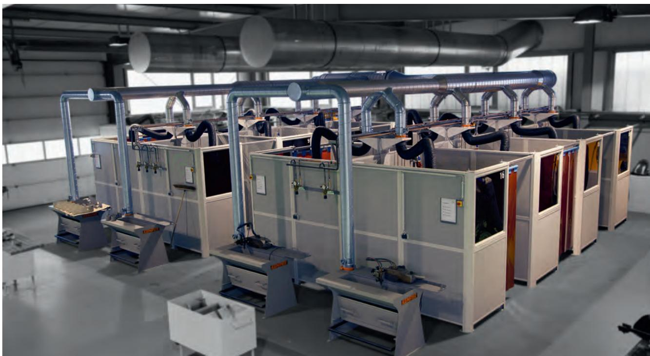
Los sistemas de paneles insonorizantes de protección de KEMPER pueden ser montados de muchas maneras gracias a sus elementos modulares fácilmente combinables. Las columnas y travesaños son de acero perfilado y están cubiertos de polvo de acero que repele los rayos UV.
