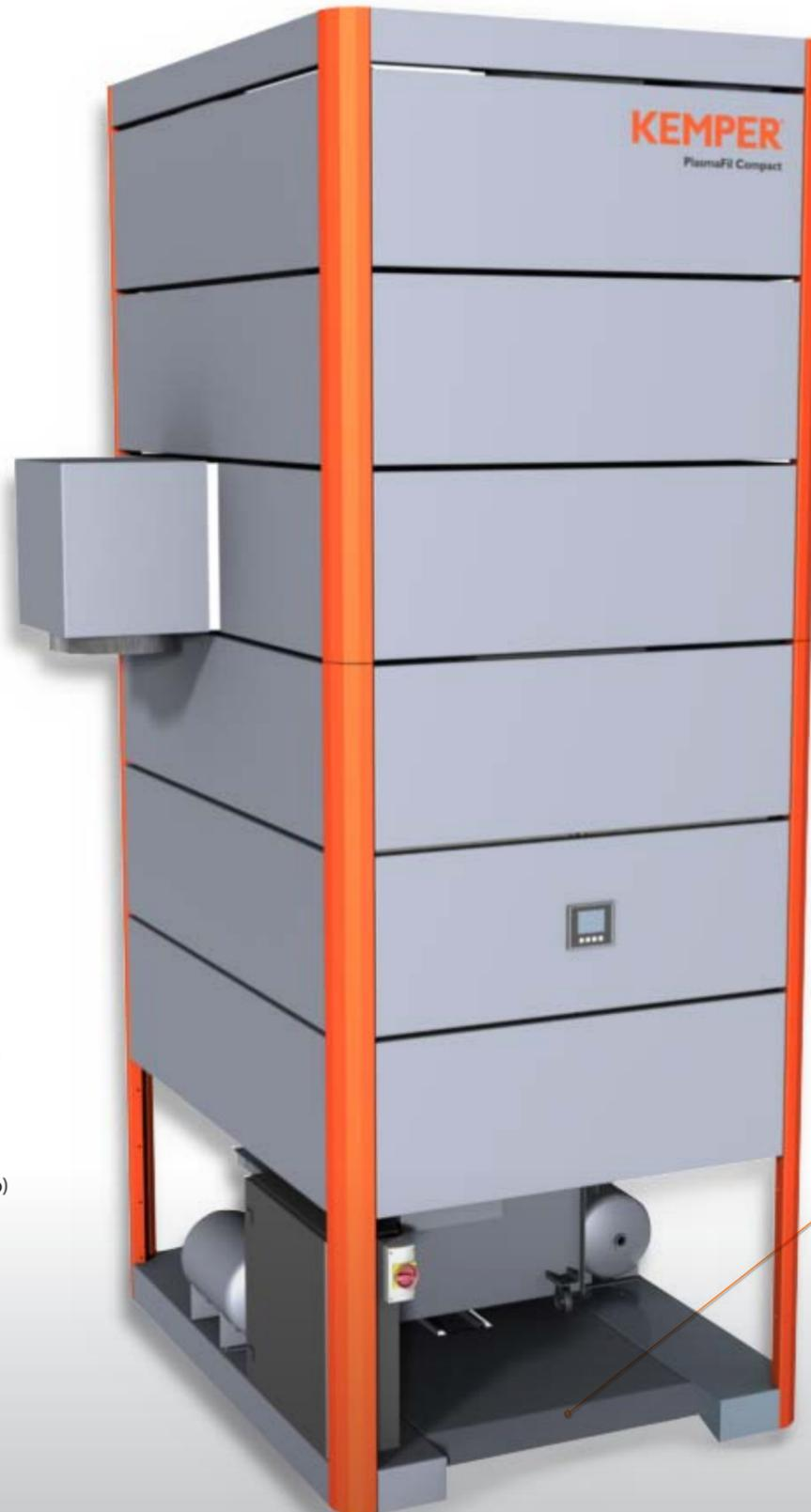
PlasmaFil Compact/WeldFIL Compact es particularmente adecuado para la instalación de sistemas de aspiración centrales o la conexión a máquinas de corte, se puede extender flexiblemente y montar en diferentes lugares. El sistema cuenta con una tecnología de filtros de placas especialmente duradera con limpieza automática. La eliminación de polvo se realiza mediante colectores de polvo.
